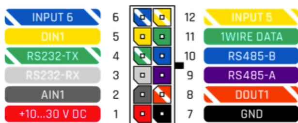
Tabelle: Pin-Belegung für Strom- und I/O-Anschluss
