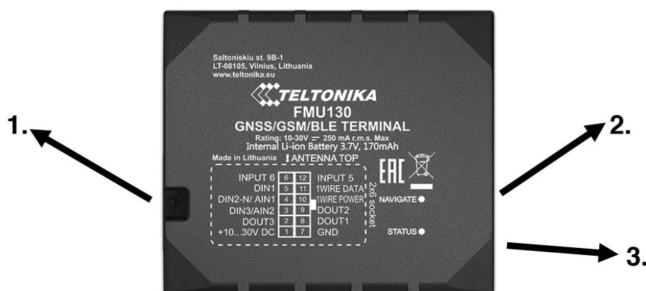
Auf der linken Seite finden Sie einen Strom- und I/O-Anschluss (1); auf der rechten Seite zwei Status-Leuchtdioden (2,3) für Navigation & Status. Der Strom- und I/O-Anschluss bildet die Hauptelektrik- und Datenschnittstelle zwischen dem Host-Fahrzeug und dem mO Mini-Gerät.
